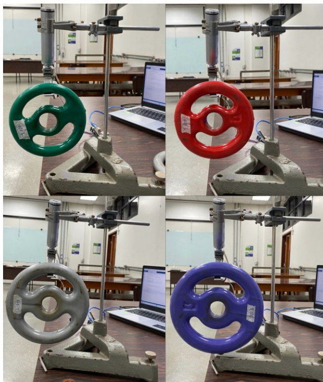
Figura 9 – Aplicação de massas sobre a lâmina do laringoscópio fixado, durante os testes experimentais para avaliação da resposta do sistema.
