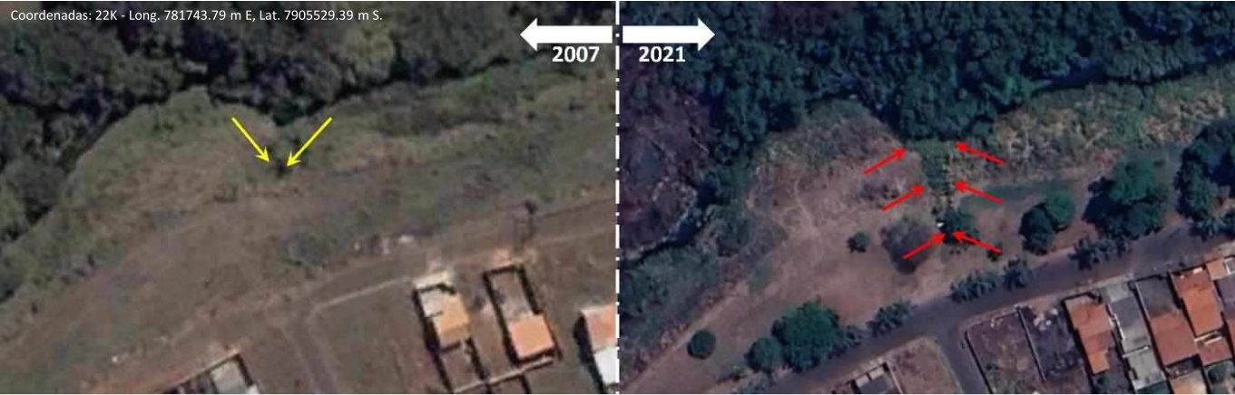
Ilustração lançamento pluvial na APP do córrego do Óleo, margem direita da MB-11. A imagem aérea de 2007 registra o local original do dispositivo de lançamento, próximo à margem do córrego. Em 2021 nota-se que o dispositivo ruiu e desenvolveu-se uma erosão regressiva. Fonte: Google Earth 2007 e 2021.
