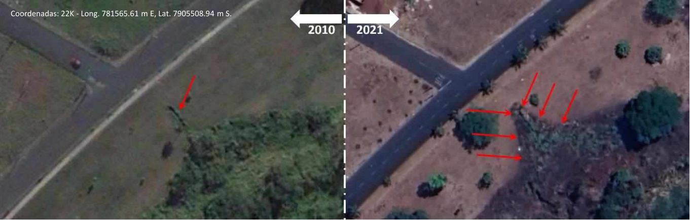
Ilustração lançamento pluvial na APP do córrego do Óleo, MB-11. A imagem aérea de 2010 registra o sulco provocado pelo lançamento de galeria pluvial. Em 2021 a erosão já evoluiu para ravina, com degradação ambiental do entorno. Fonte: Google Earth 2010 e 2021.
