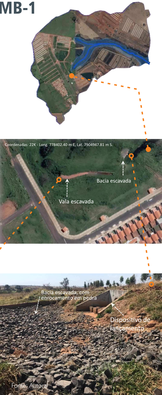
Imagens de dispositivos de lançamento pluvial e dissipação de energia implantados em regiões de várzea (MB-1). Fonte: Autoral.
