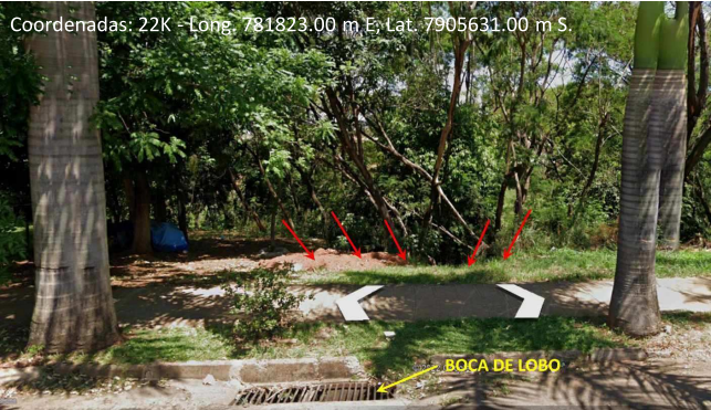
Ilustração Lançamento pluvial na APP do córrego do Óleo, MB-4, com ocorrência de ravina – setas vermelhas indicam o início da ravina. Fonte: Street View – Google Earth 2019.
