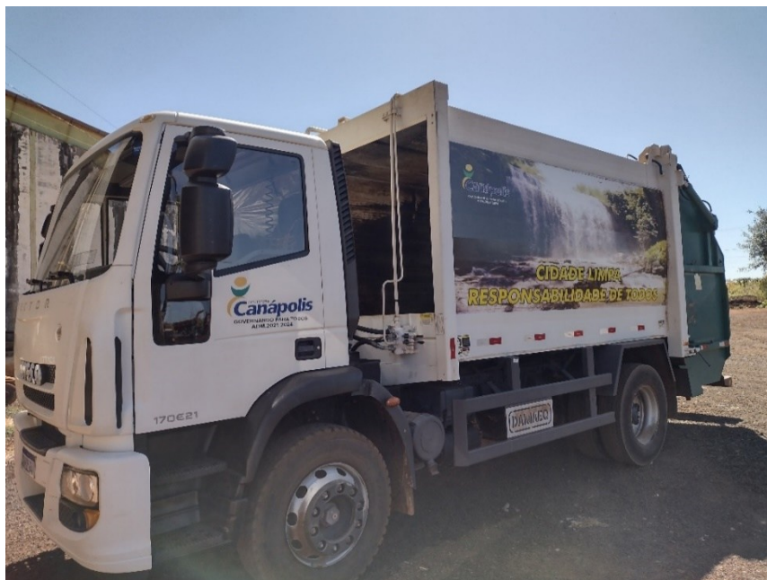
Figura 6 - Veículo compactador utilizado no serviço de coleta de resíduos domiciliares em Canápolis (MG).
