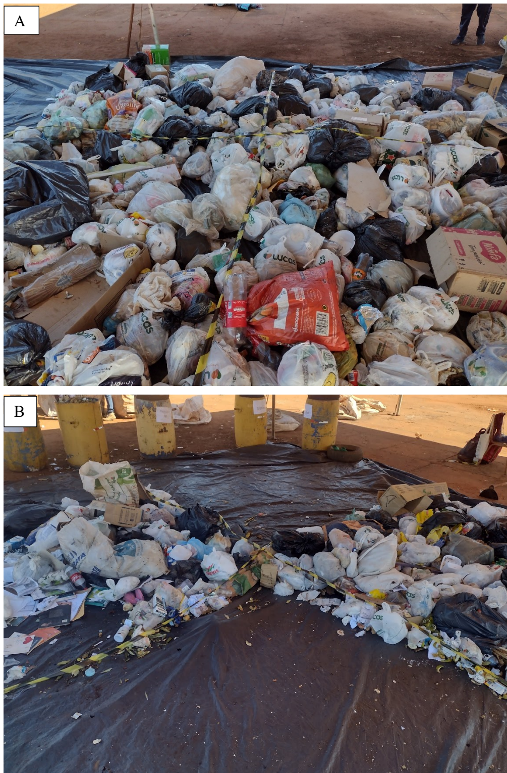
Figura 14 - Primeira etapa do quarteamento para análise da composição gravimétrica dos resíduos domiciliares de Canápolis (MG).
