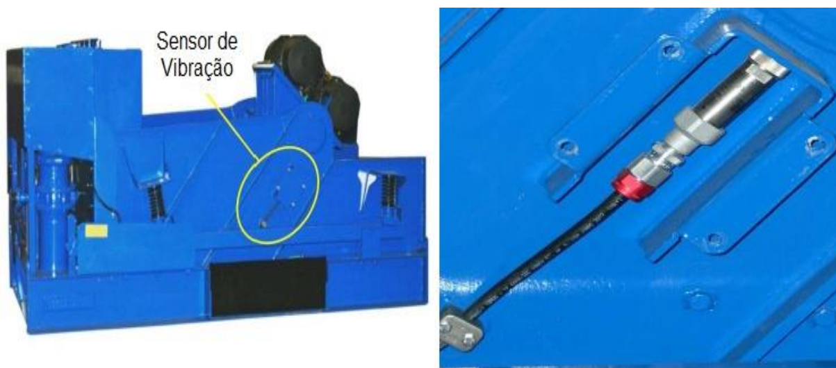
Figura 2.11 - Destaque para sensor de vibração em peneira vibratória
