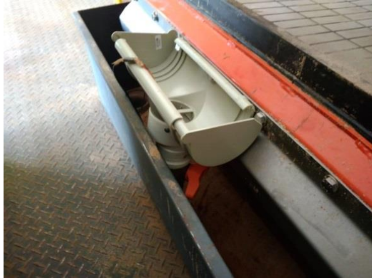
Figura 3.7 - Amostrador desenvolvido para medição contínua de umidade
