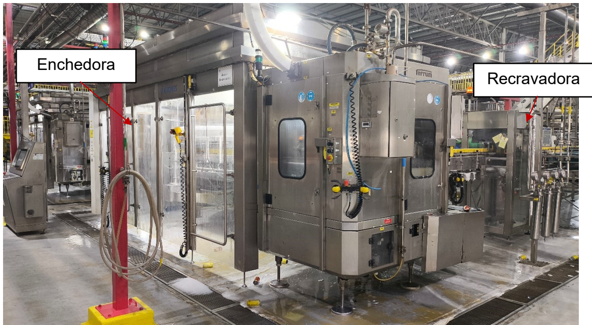
Figura 7. Enchedora de latas a esquerda e recravadora de latas a direita.
