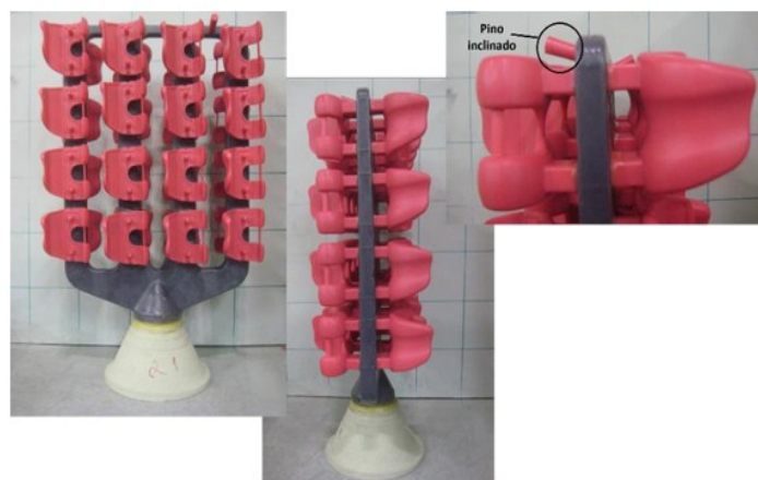
Figura 13 - Árvore montada com 32 moldes femorais de cera, em destaque o pino para extração de cera no molde cerâmico (MACHADO, 2018).
