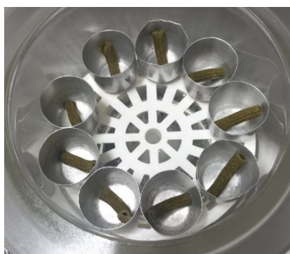
Figura 9 – Amostras em dessecador contendo solução saturada de cloreto de sódio.
