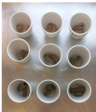
Figura 8 – Cadinhos com amostras de macarrões secos após análise de umidade final.
