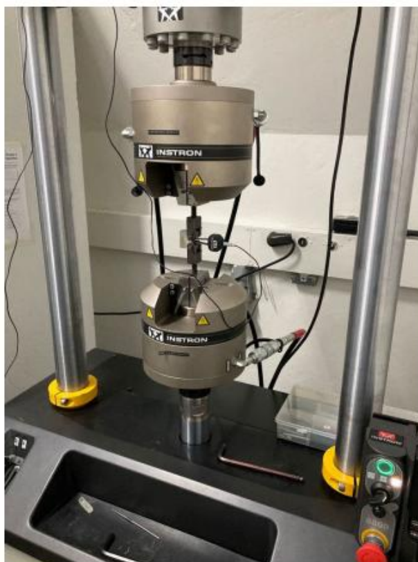
Figura 2.22 - Máquina de fadiga servo-hidráulica Instron® modelo 8801 (BASÍLIO, 2022).
