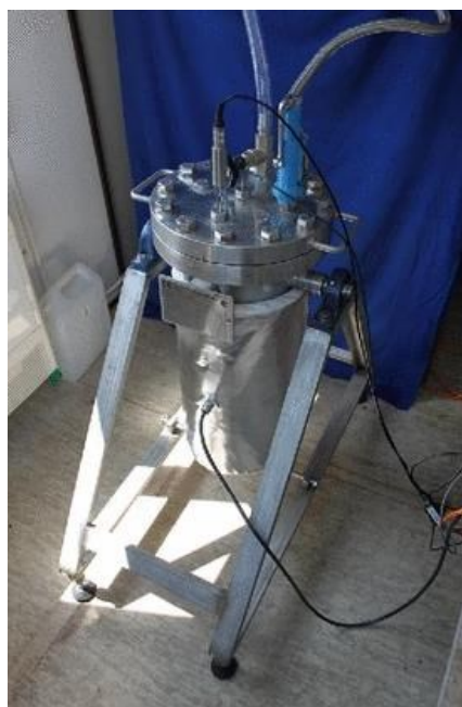
Figura 12 - Reator típico de processos hidrotérmicos para conversão de biomassas
