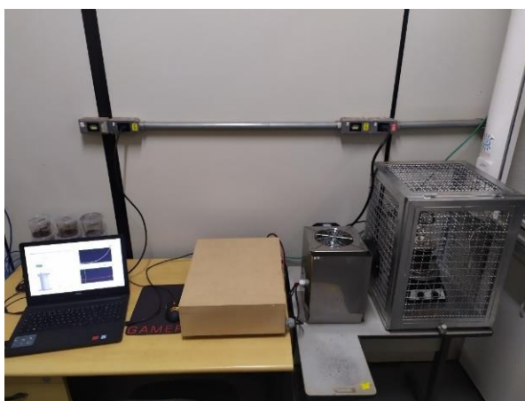
Figura 18 – Sistema de carbonização hidrotérmica acoplado ao computador.
