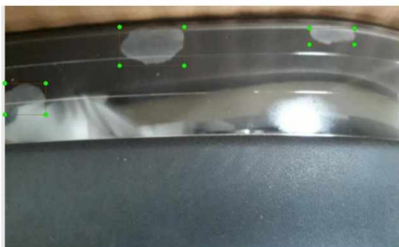
Figura 12 – Exemplo de marcação de foto utilizando labelImg, de um defeito em um vidro (GONZAGA, 2023)
