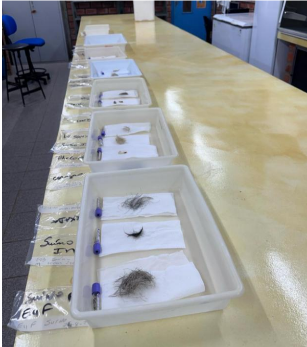
Figura 3 Amostras secando com acetona após serem lavadas
