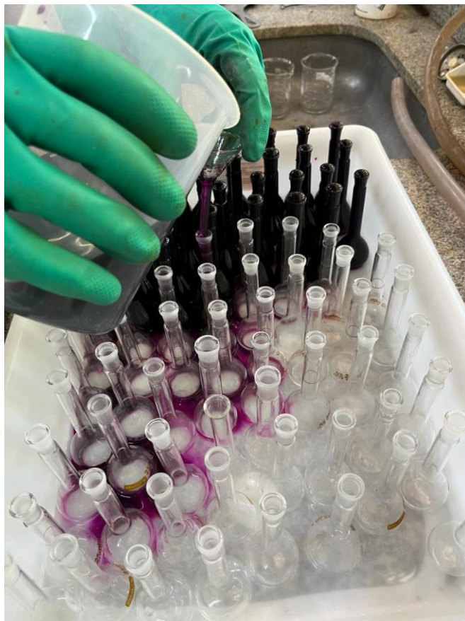
Figura 5 Descontaminação com permanganato de potássio 5%
