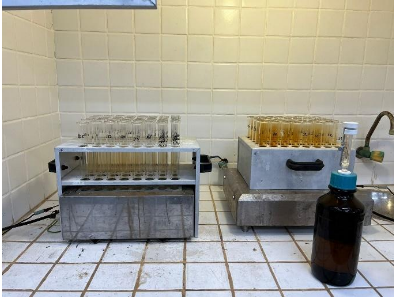
Figura 9 Amostras sendo digeridas nas placas de digestão a 230°
