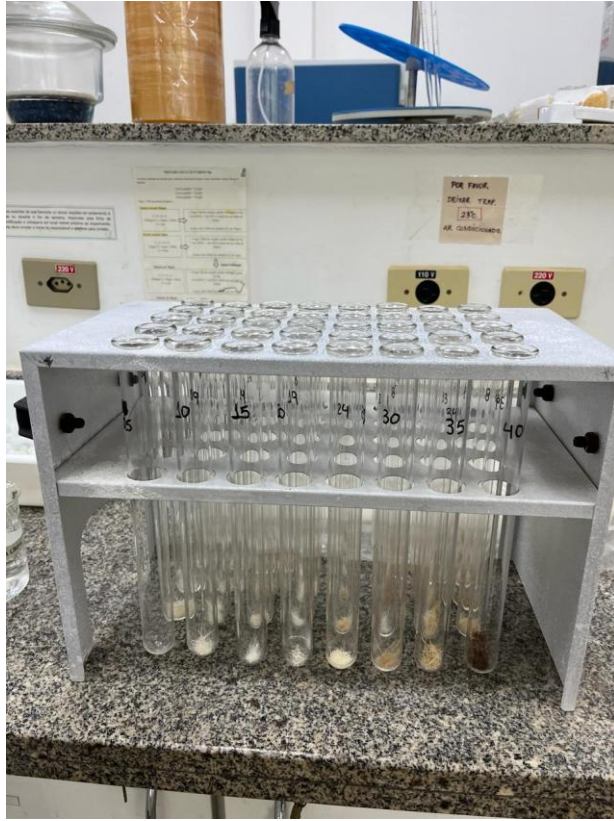
Figura 6 Amostras devidamente identificadas nos tubos de ensaio prontas para o processo de digestão
