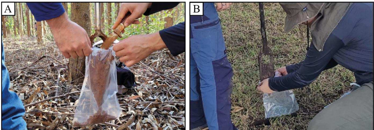
Figura 4: A) Coleta de amostra deformada de Latossolo Vermelho Amarelo; B) Coleta de amostra de Gleissolo Melânico utilizando o trado.
