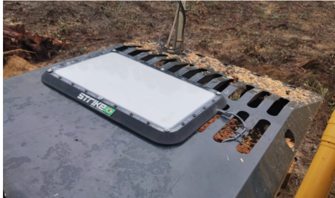
Figura 16 – Antena Starlink utilizado no Feller
