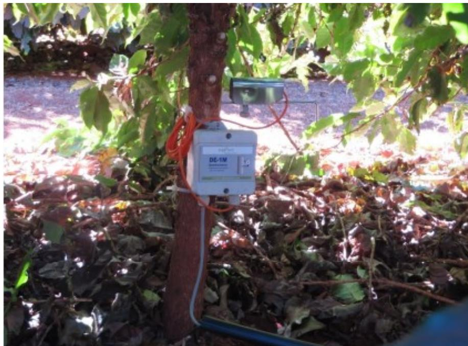
Figura 4. Dendrômetro DE-1M instalado na planta monitorada.
