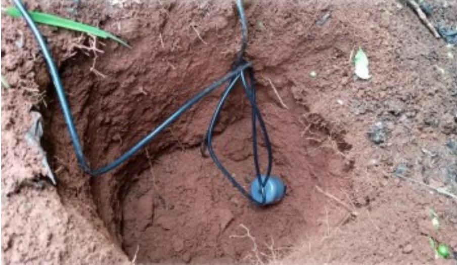
Figura 5. Sensor de umidade de solo MAS-1, instalado na profundidade de 0-20 cm.
