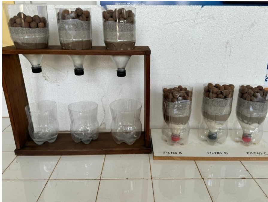
Figura 2- Filtros de areia.
