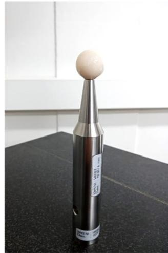
Figura 3. 8 – Apalpador com ponta de rubi (a). Haste com esfera de cerâmica, para calibração da ponta do apalpador.
