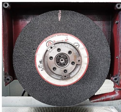
Figura 3. 3 – Posicionamento do rebolo abrasivo de SiC junto a máquina retificadora.
