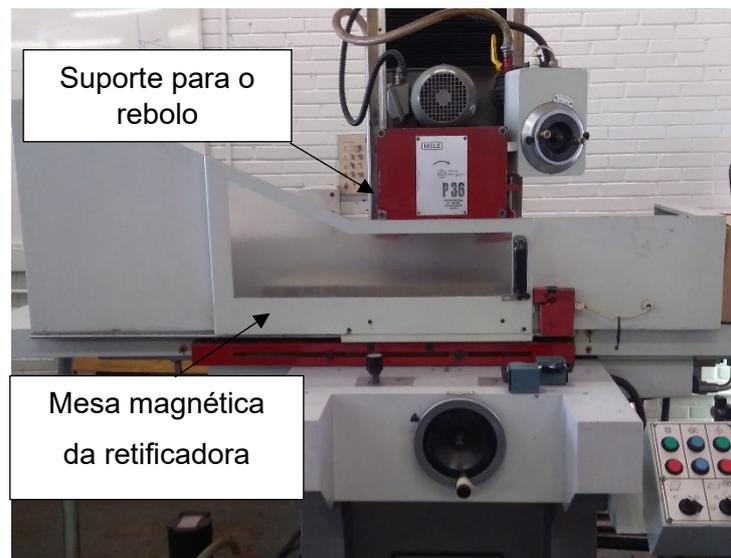
Figura 3. 2 – Retificadora plana tangencial P36 MELLO S.A, disponível no Laboratório de Usinagem Convencional (LUC-UFU).
