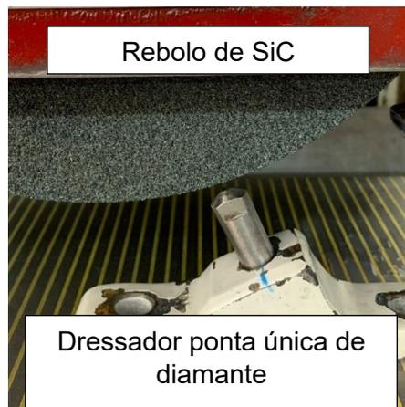
Figura 3. 4 – Posicionamento do dressador ponta única de diamante junto ao rebolo de SiC.
