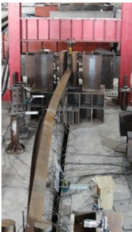
Figura 3 – Instabilidade lateral com torção em viga
