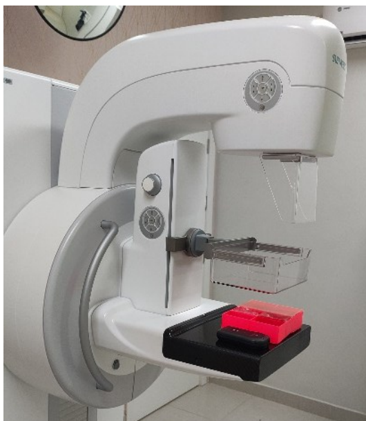
Figura 2: Mamógrafo Siemens com medidor multiparamétrico e simulador de mama
