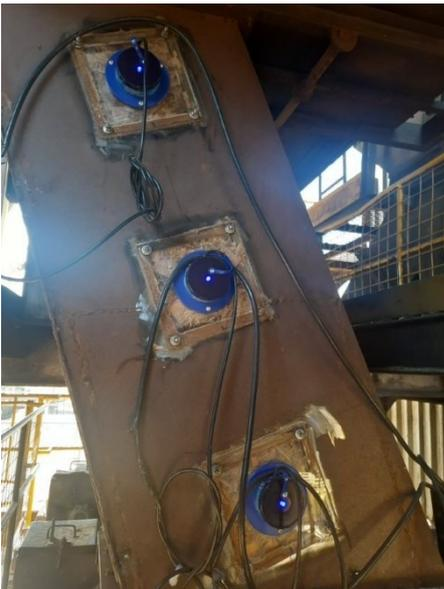
Figura 18: Instalação dos sensores de movimento das bicas de alimentação
