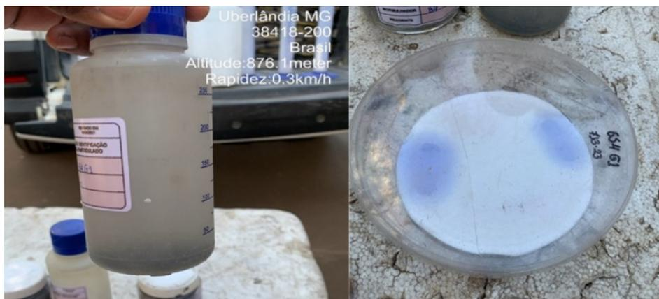
Figura 20: Material particulado e filtro para a proporção de 50% de bagaço de cana
