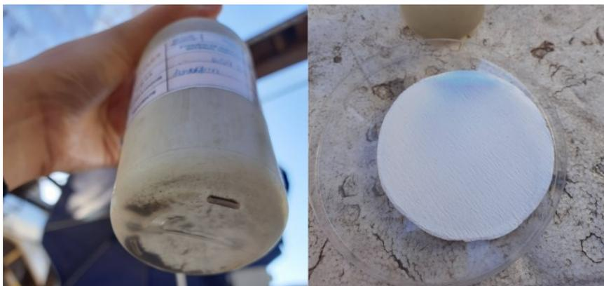
Figura 19: Material particulado e filtro para a proporção de 25% de bagaço de cana
