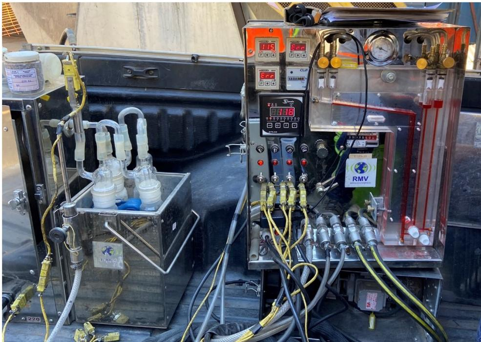
Figura 22: CIPA utilizado para medição das emissões de gases
