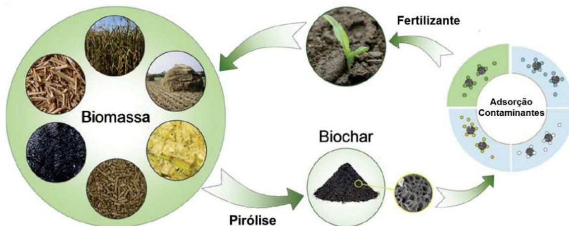
Figura 12 - Esquema de obtenção e aplicação de biochar a partir de biomassa.
