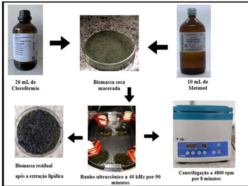
Figura 31 - Procedimento de extração lipídica utilizando banho clorofórmio, metanol, banho ultrassônico e centrifugação utilizando a biomassa seca macerada.
