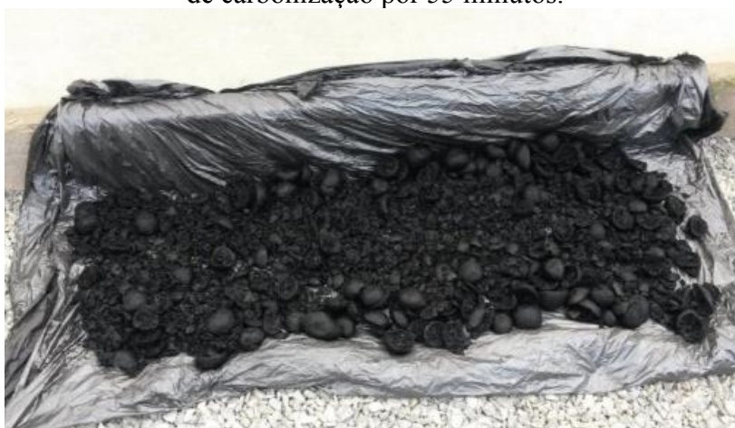
Figura 13 - Exemplo de produção de biocarvão a partir do bagaço de laranja em um processo de carbonização por 55 minutos.
