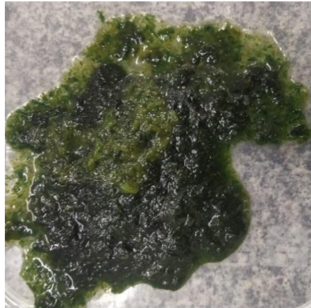
Figura 29 - Biomassa úmida da co-cultura de microalgas e cianobactérias posterior ao processo de centrifugação.
