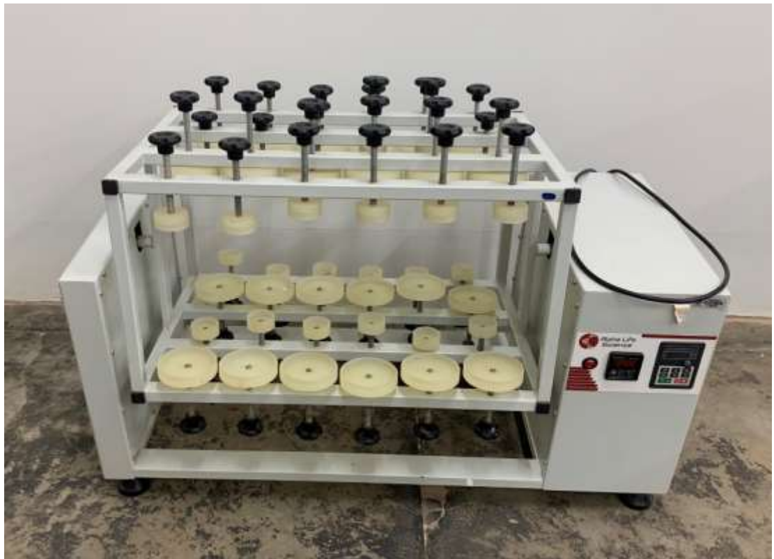
Figura 3. Agitador tipo Wagner utilizado no processo de separação granulométrica para a etapa de agitação das amostras
