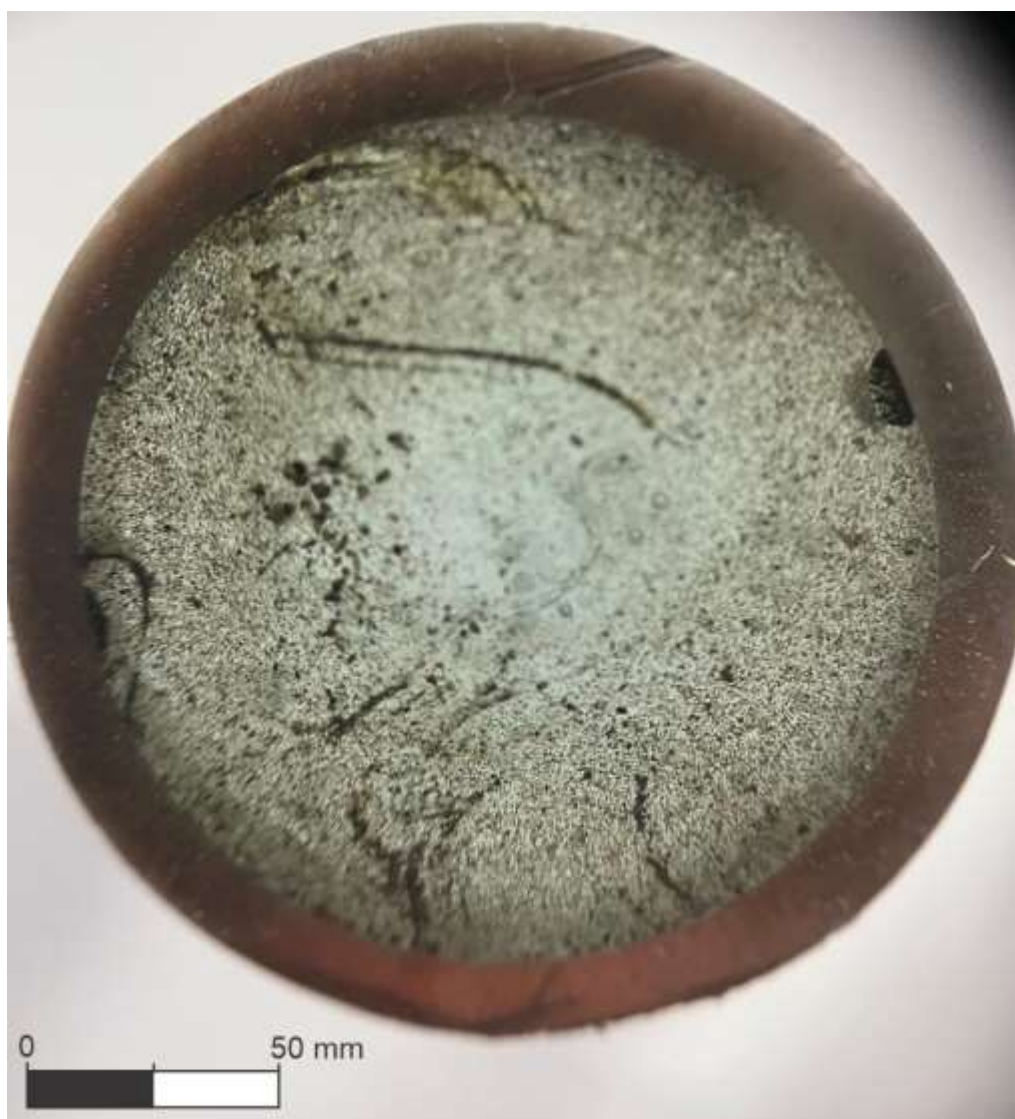
Figura 5. Seção polida desenvolvida para análise de minerais de forma isolada.
