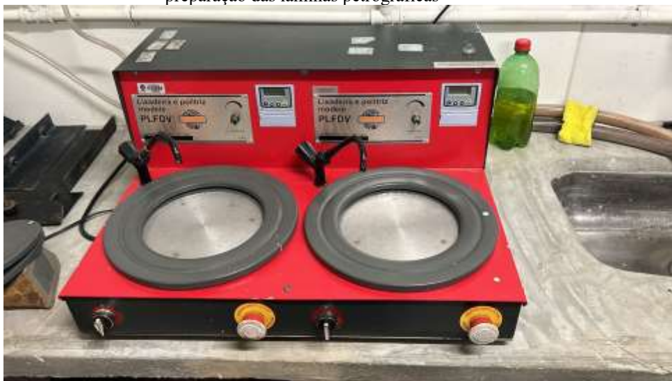
Figura 9. Lixadeira metalográfica PLFDC dupla da Fortel utilizada para o desbaste das amostras durante a preparação das lâminas petrográficas
