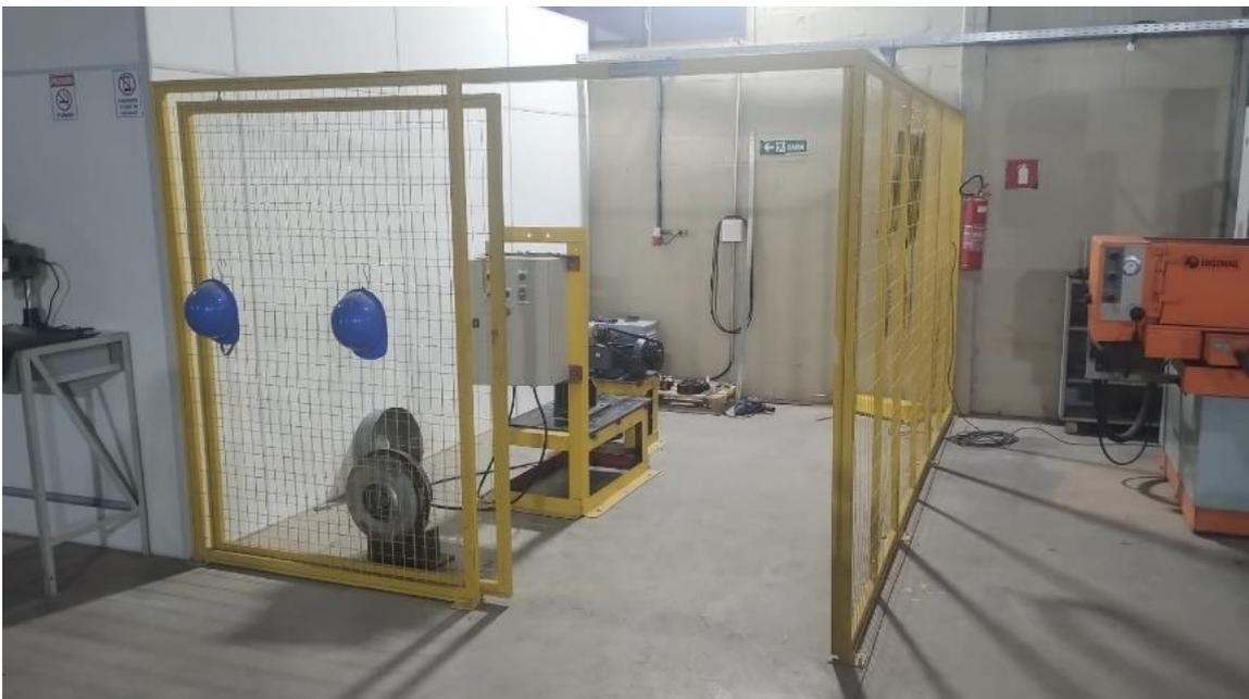
**Figura 7.** Gaiola da bancada de balanceamento.
