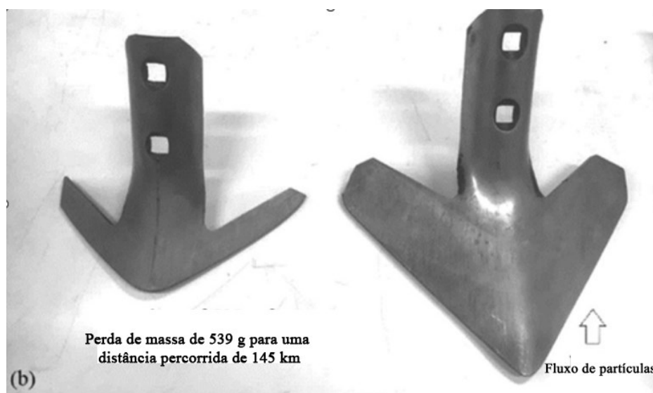
Figura 18 - Lâminas de arado desgastada (esquerda) comparada a uma lâmina nova (direita).
