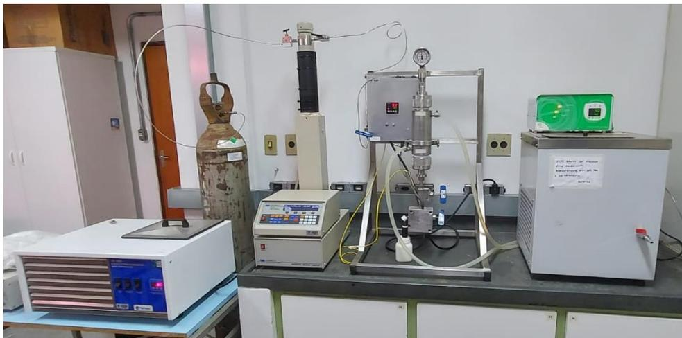
Figura 6 – Unidade de extração supercrítica em operação – Fonte: O Autor (2023).
