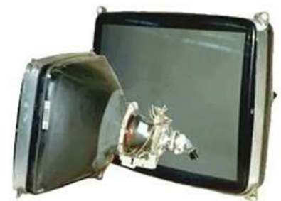
Tubo de vidro de uma televisão de tubo
