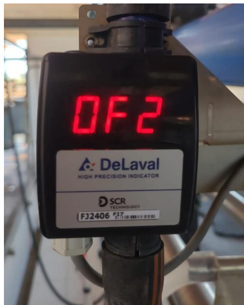
Figura 3 Medidor utilizado para mensuração da produção de leite individual.
