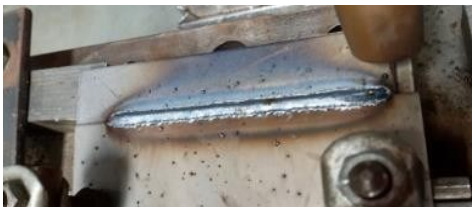
Figura 72: Cordão de solda 5G com o gás Ar8%CO 2
