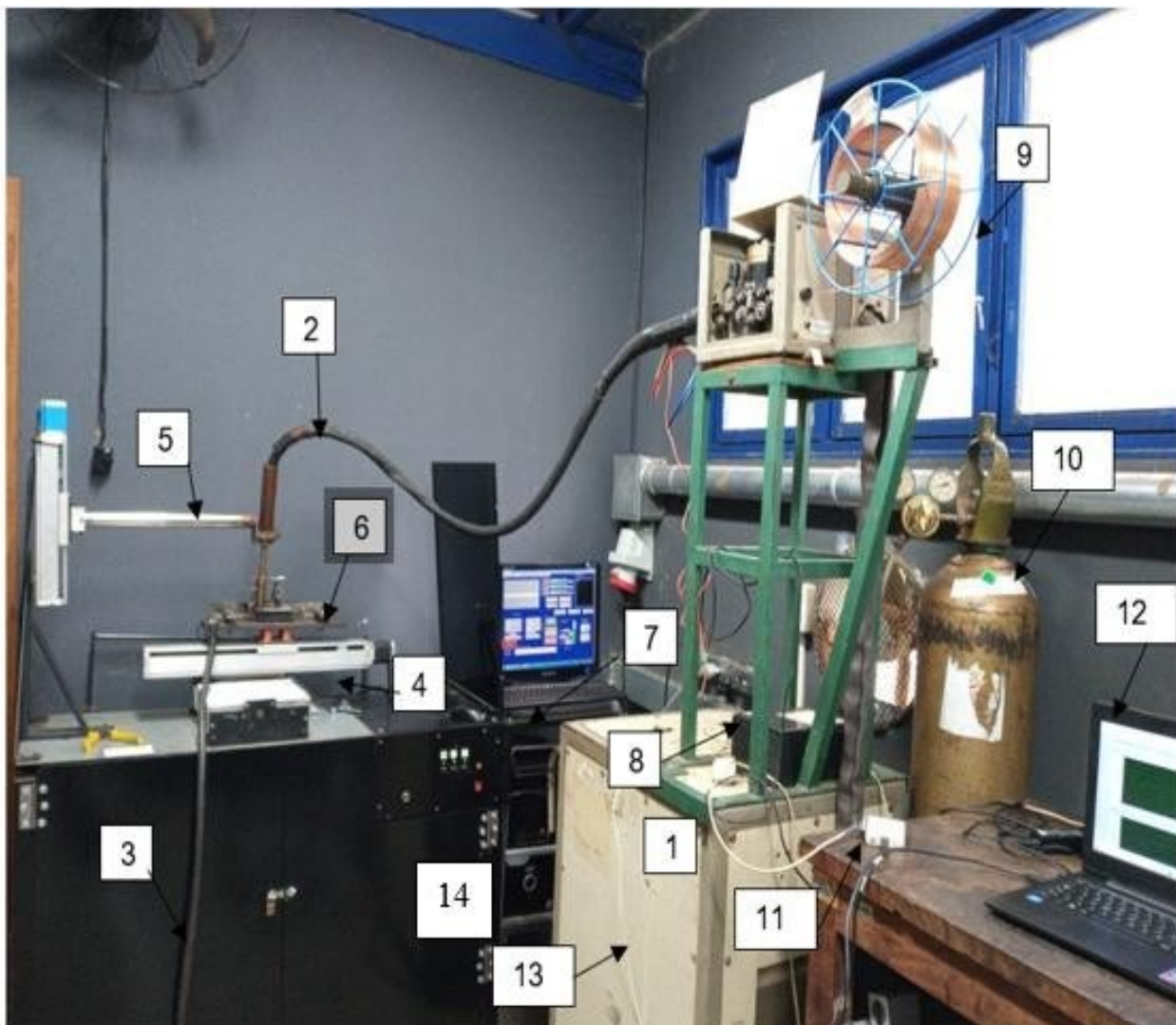
Figura 51: Bancada Experimental: 1 – Fonte de soldagem; 2 – Tocha de soldagem; 3 – Cabo terra da fonte de soldagem; 4 - Carrinho de movimentação; 5 – Sistema de controle de ajuste automático da DBCP; 6 – Suporte para prender as chapas; 7 – Monitor e CPU para controle e inserção de variáveis do processo de soldagem através de código G; 8 – Sistema condicionador de sinais; 9 – Arame ER110S-G de 1.2 mm; 10 – Cilindro de gás; 11 – Placa de aquisição de dados (National Instruments-modelo NI USB 6009); 12 – Notebook com sistema de Labview; 13 – Acionamento manual da fonte de soldagem; 14 – Sistema de movimentação.
