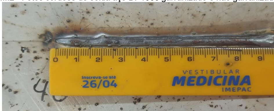
Figura III.2 - Fotos cordões de solda aço DP1000 galvanizado e não galvanizado
