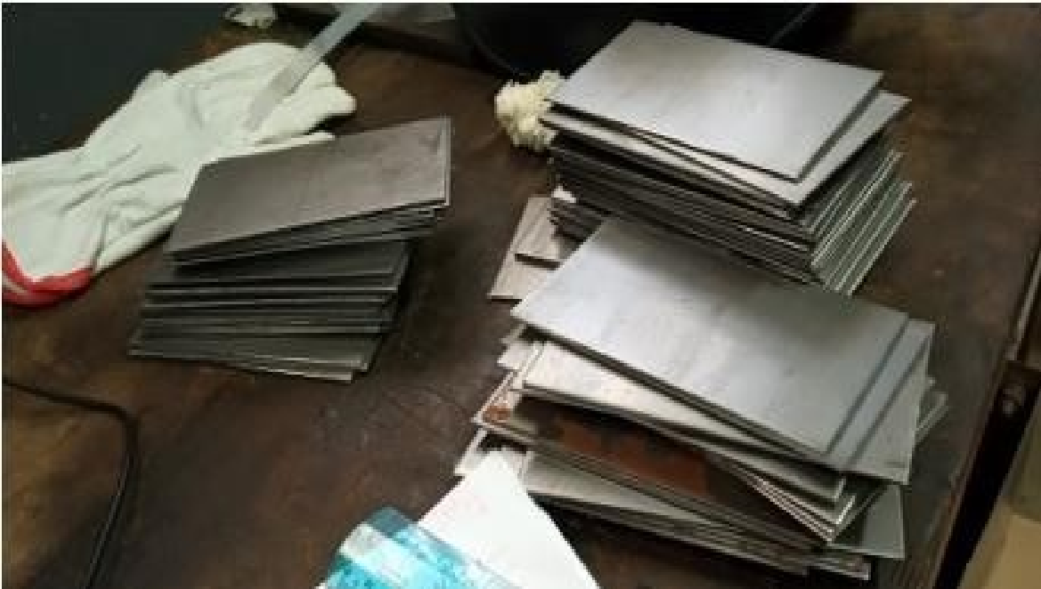
Figura 63: Chapas de aço carbono 16 para parametrização de soldagem
