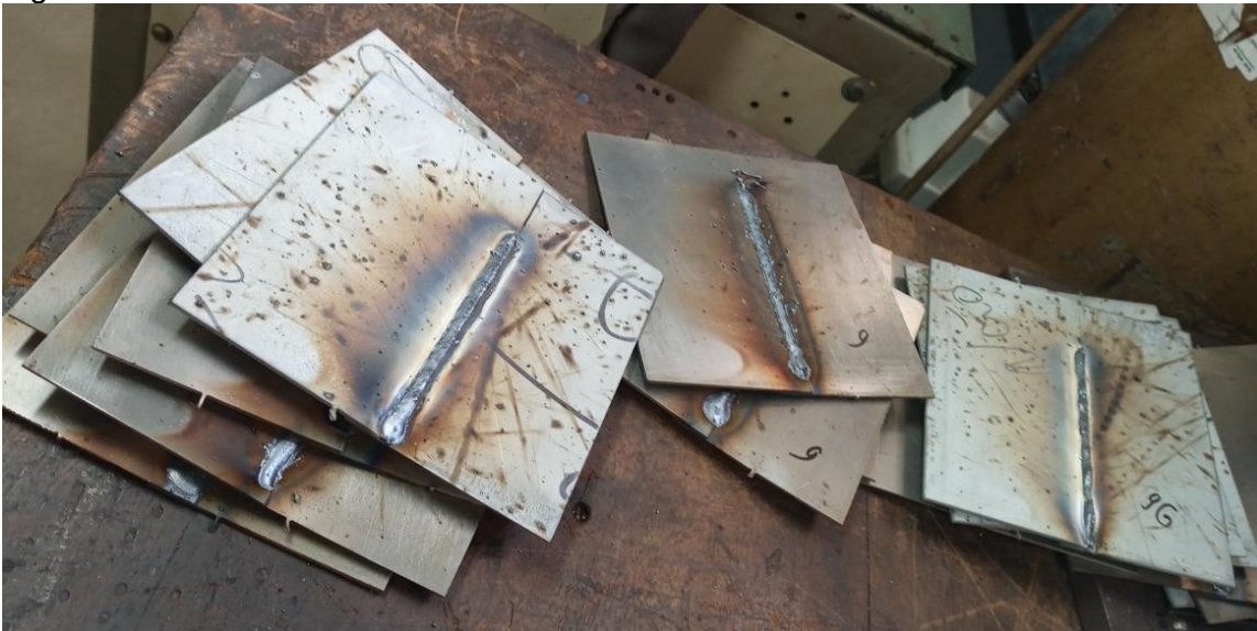
Figura III.1 - Fotos cordões de solda
