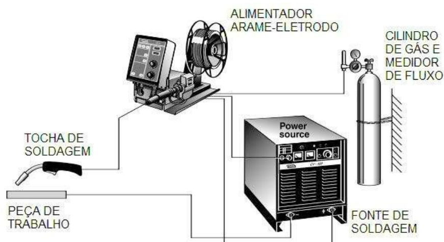
Figura 16: Circuito de soldagem GMAW
