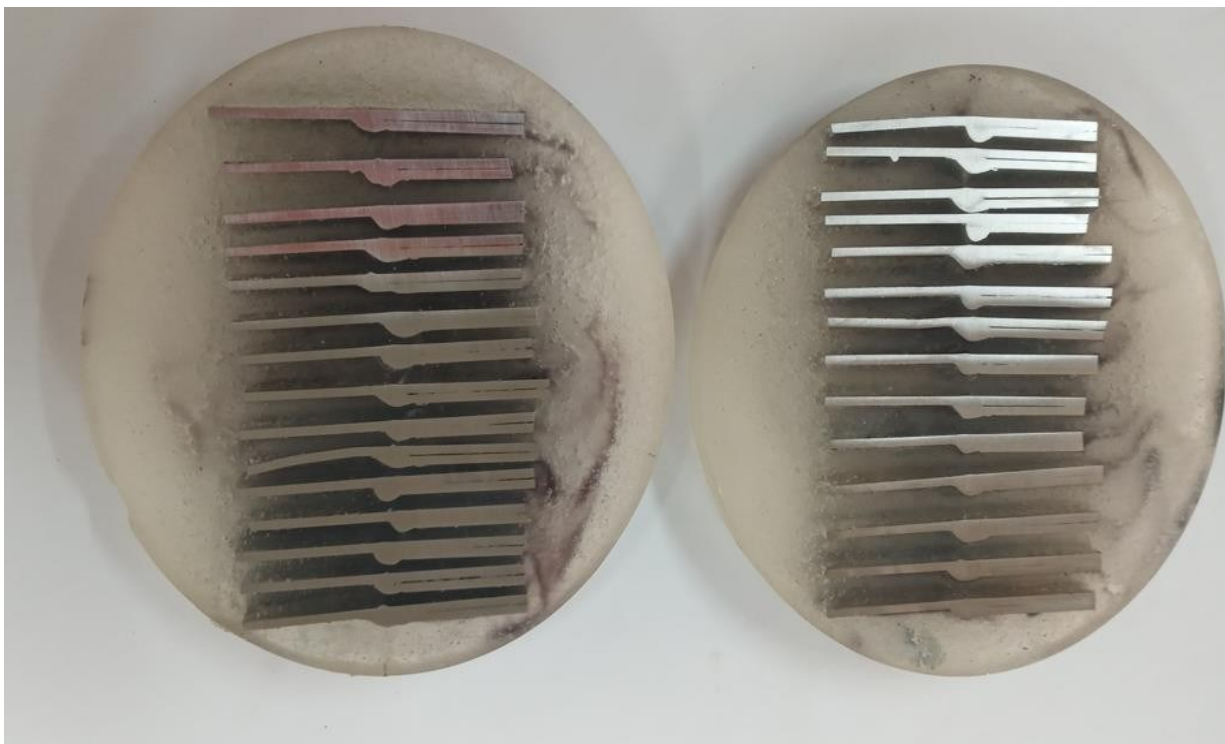
Figura 76: Amostras cordões de solda DP 1000 galvanizado e não galvanizado embutidas a frio
