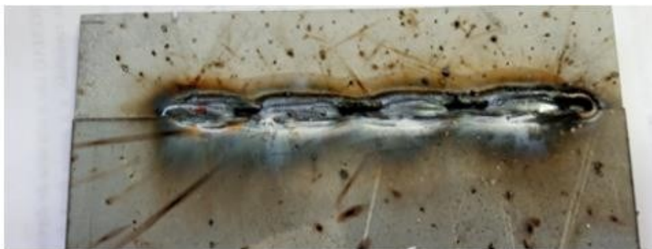
Figura 71: Cordão de solda 20G com o gás Ar25%CO 2 .
