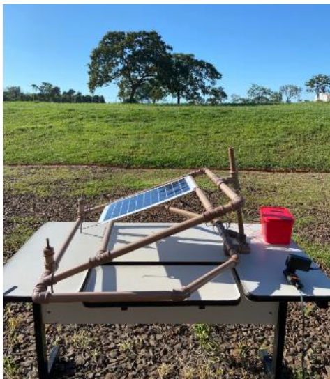
e) Arranjo fotovoltaico completo Fonte: Autoria própria.
