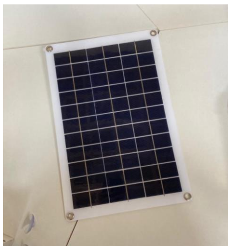
a) Placa fotovoltaica
