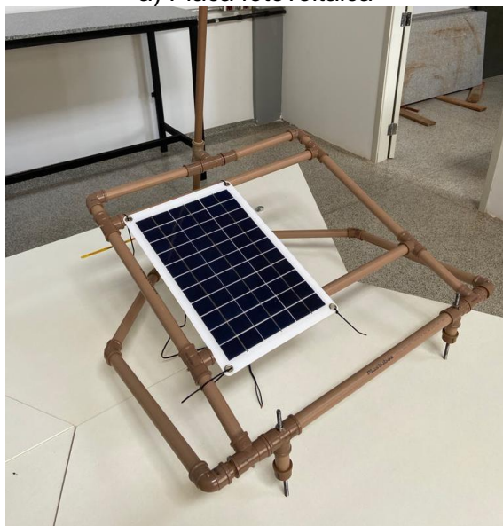
c) Montagem da placa solar na estrutura do Rastreador
