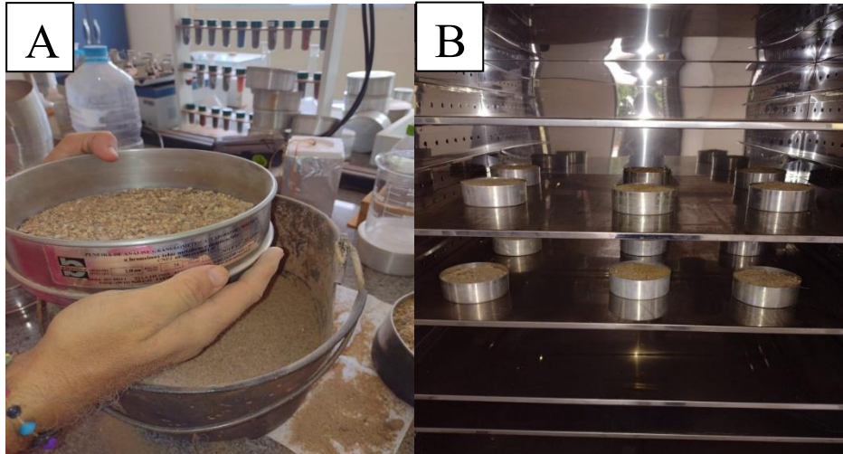
FIGURA 7: Areia sendo peneirada (A). Areia dentro da estufa para esterilização (B).
