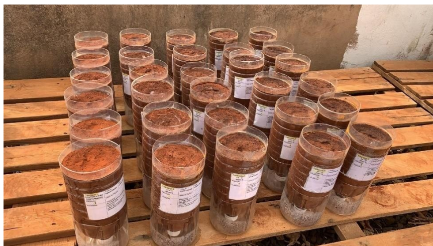
Figura 01: Unidades experimentais compostas por colunas de recipientes plásticos contendo 1,1 dm 3 de solo argiloso.
