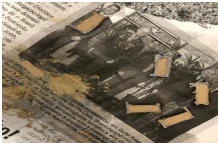
Figura 4- Placas com 0,4% de carbon black após o empaste
