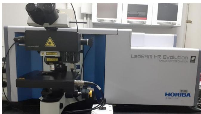
Figura 27 – Espectrômetro Raman Confocal utilizado. (Imagem retirada da página da [RELAM](#)).
