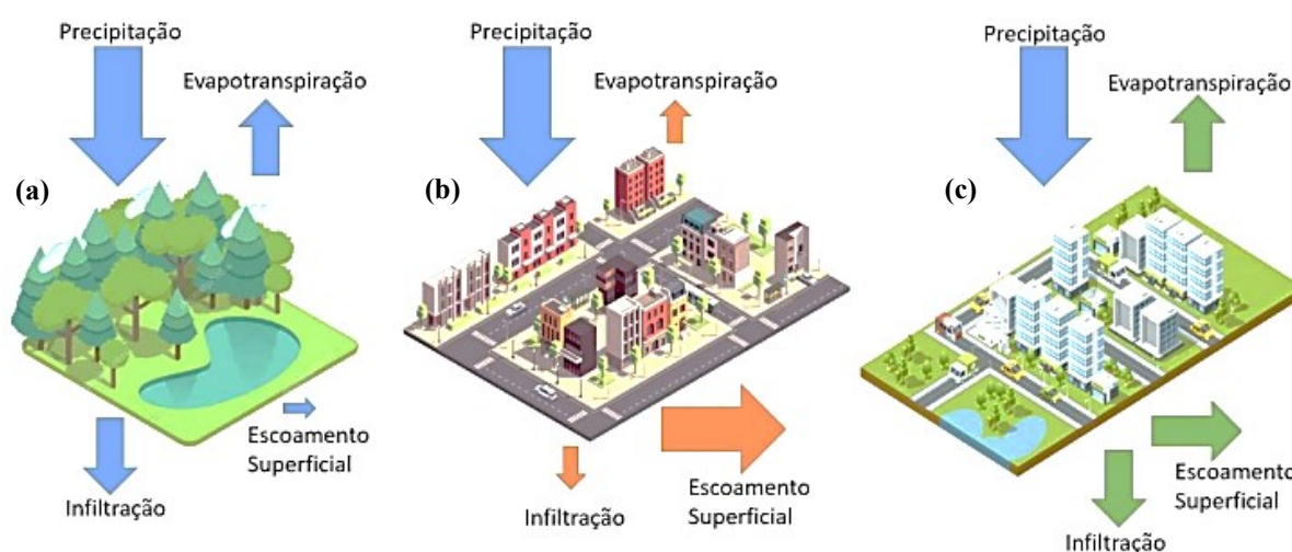
Figura 1 - Resposta hidrológica sob diferentes perspectivas de urbanização. (a) Condição pré-urbanização; (b) Condição essencialmente urbana; (c) Condição urbana combinada com soluções ecológicas. Obs.: A variação do tamanho das setas indica a variação quantitativa da variável.
