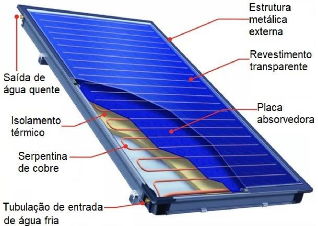
Figura 2 – Desenho esquemático de coletor solar de placa plana
