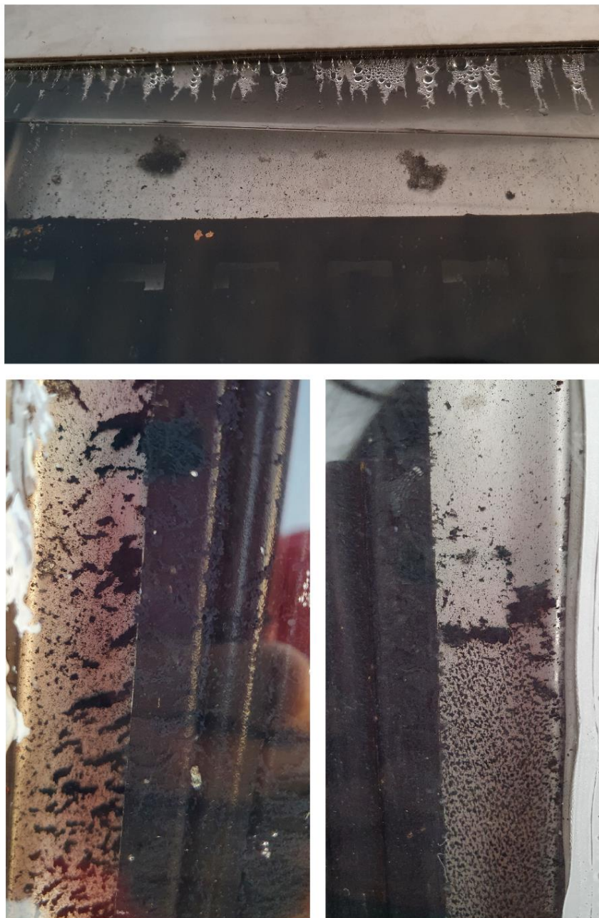
Figura 93 – Detalhes das aglomerações de nanopartículas observadas no Coletor 3 nos testes com nanofluidos MWCNT-água ( \Phi_v=0,0010\% )
