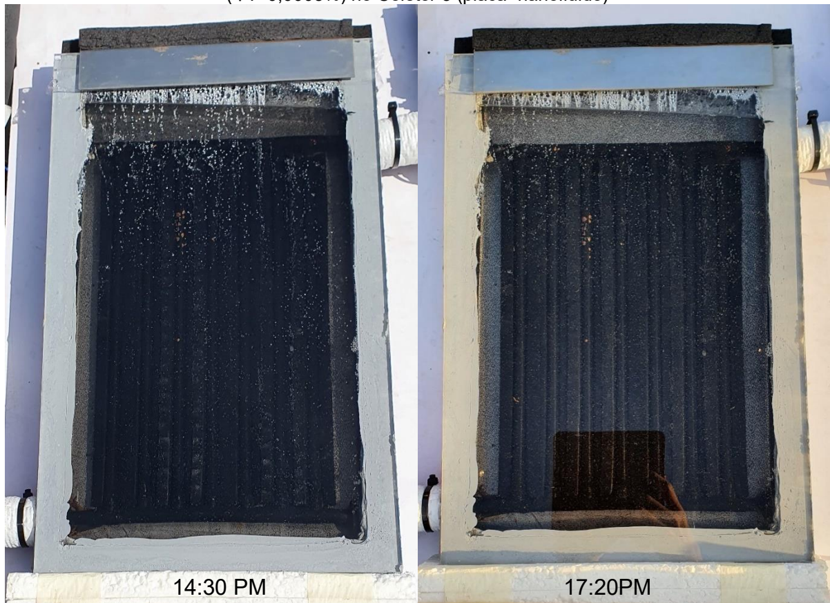
Figura 106 – Fotos comparativas ao longo do primeiro dia de testes (16/8/22) com MWCNT-água ( \Phi_v=0,0005\% ) no Coletor 3 (placa+nanofluido)
