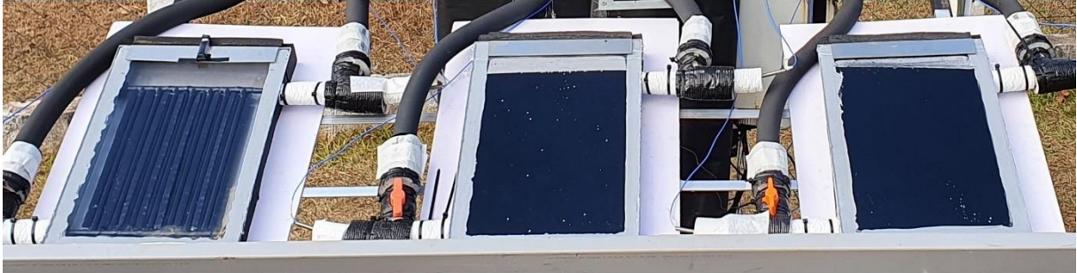
Figura 86 – Fotos comparativas da bancada 2 no início e final do dia 5/8/22 - Etapa de testes com nanofluidos MWCNT-água, \Phi_v=0,0010\%
