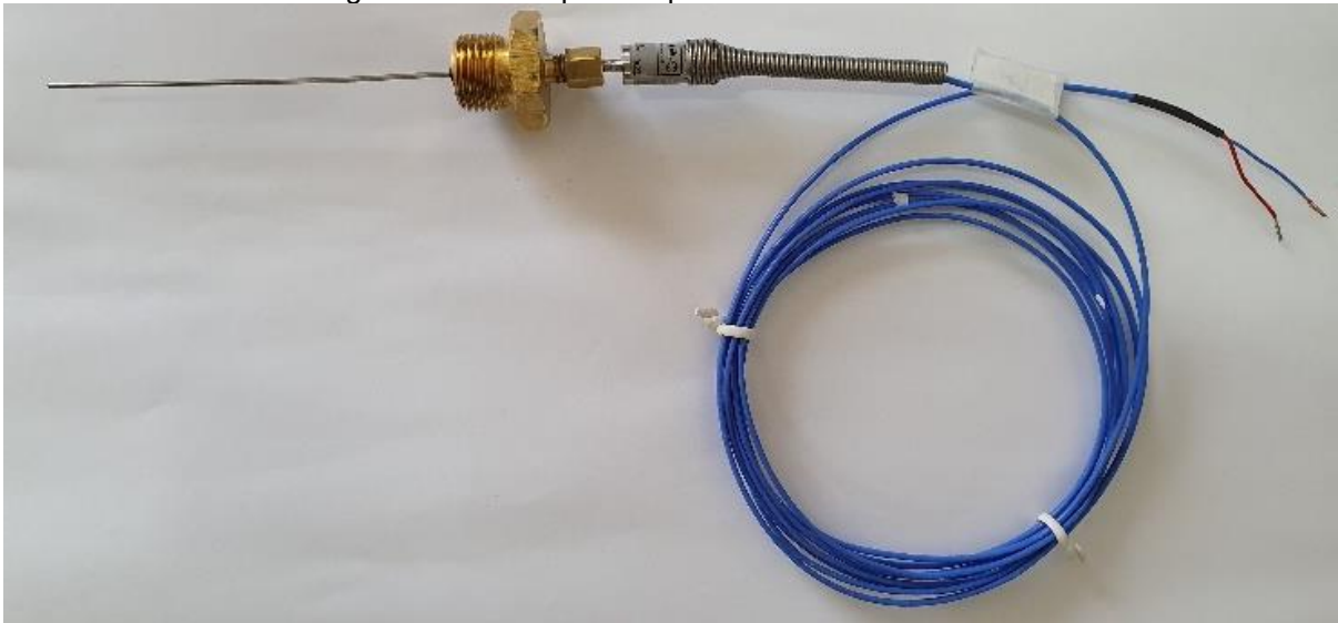
Figura 49 – Termopar do tipo T utilizado na bancada 2
