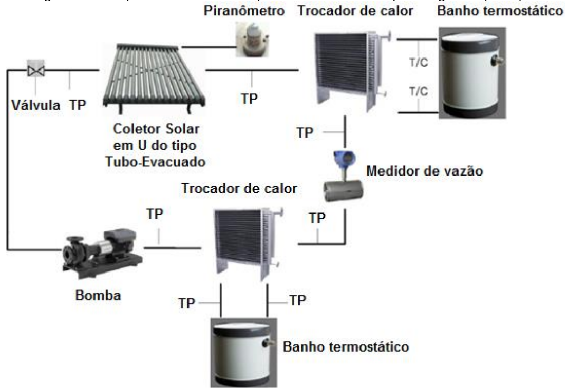
Figura 20 – Esquema da bancada experimental construída por Tong et al. (2015)
