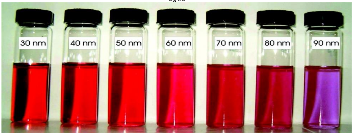
Figura 40 – Variação de cor em dispersões de nanopartículas de ouro de diferentes tamanhos em água
