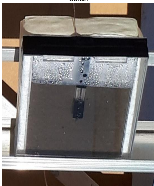
Figura 76 – Detalhe da célula de teste com nanofluido \Phi_v=0,0008\% após cinco dias de exposição solar.
