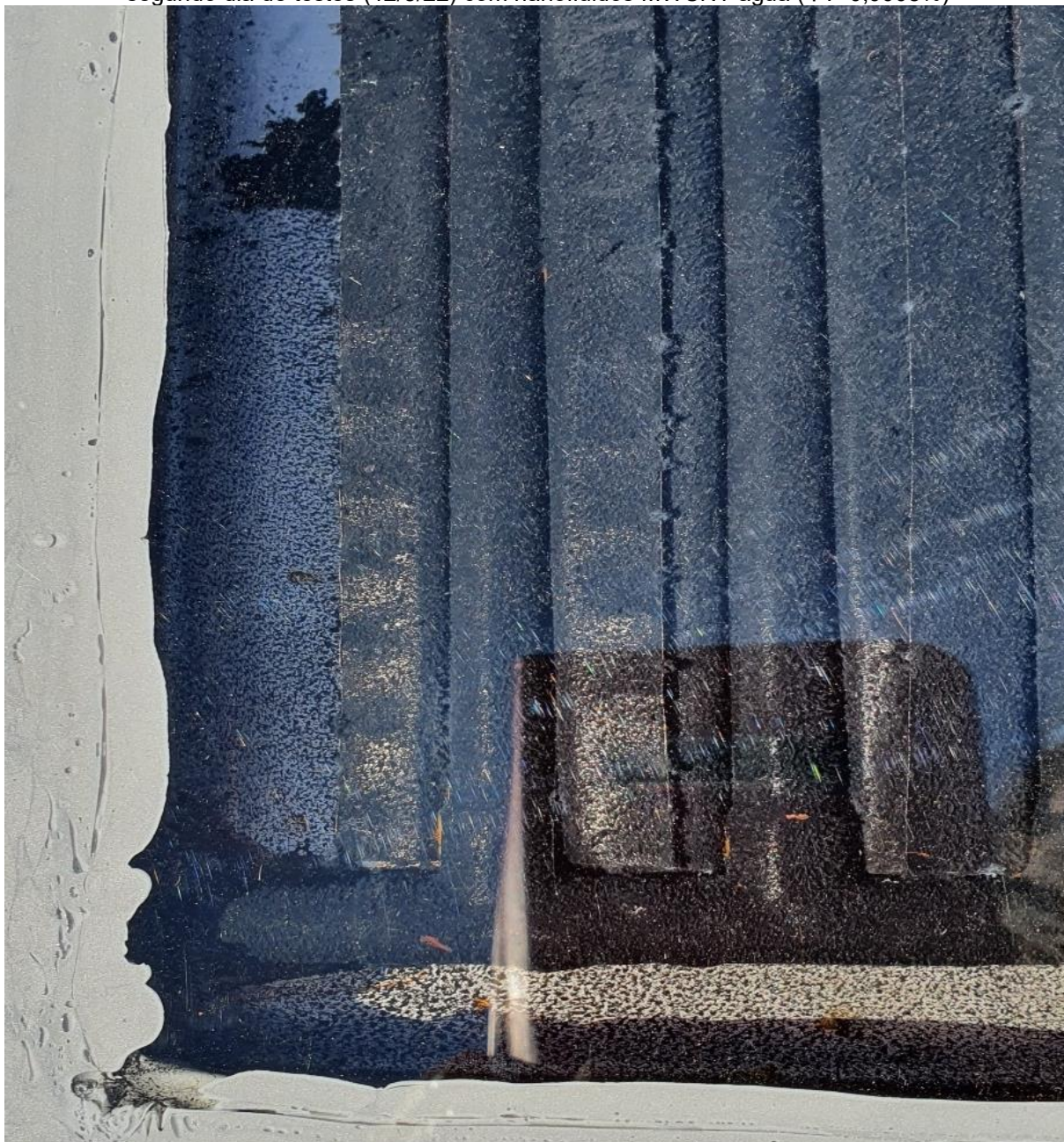
Figura 102 – Detalhes das aglomerações e deposição de nanopartículas no Coletor 3 ao fim do segundo dia de testes (12/8/22) com nanofluidos MWCNT-água ( \Phi_v=0,0008\% )
