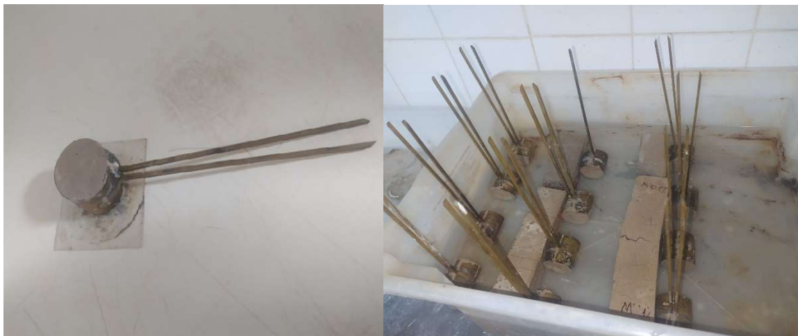
Figura 20: Ensaio da expansibilidade pelo método das agulhas de Le Chatelier
