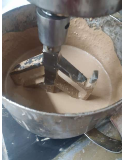
Figura 11: Mistura dos materiais do compósito sem fibra em argamassadeira.
