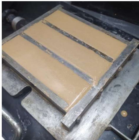
Figura 13: Exemplo de amostra de compósito de cimento MOS, no estado fresco, colocada nos moldes prismáticos (40x40x160).
