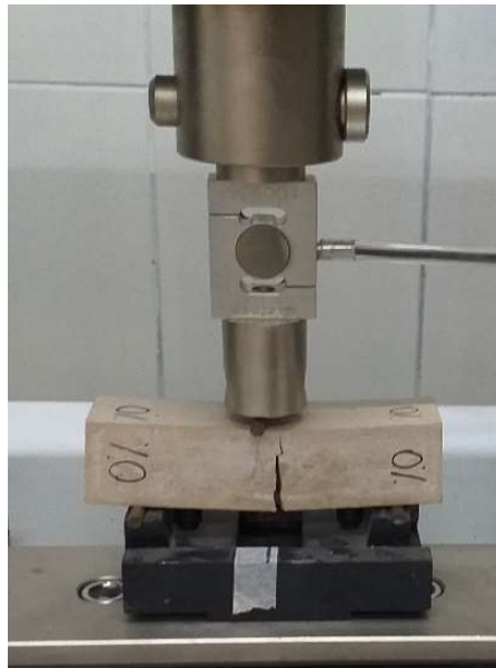
Figura 21: Ensaio de flexão realizado segundo ASTM C348.
