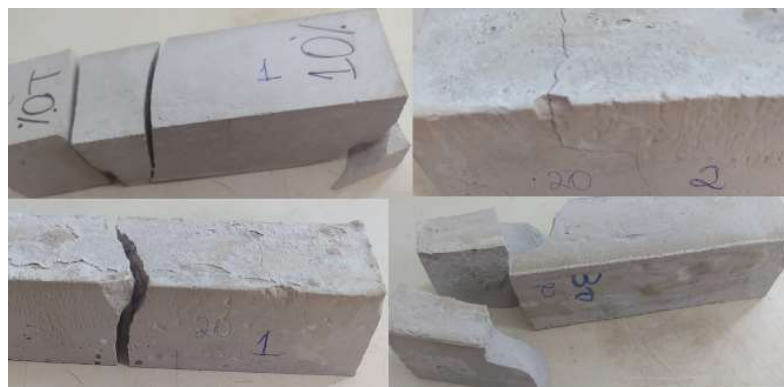
Figura 17: Corpos de prova fissurados e quebrados com o ensaio
