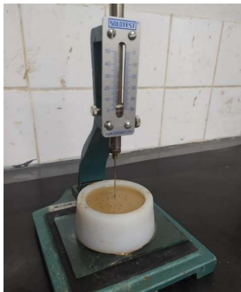
Figura 16: Ensaio de tempo de pega no aparelho de Vicat.
