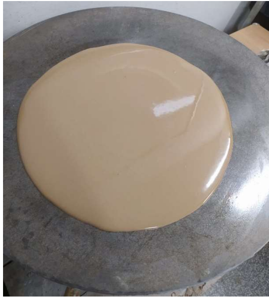
Figura 15: Determinação da consistência dos compósitos pelo ensaio de espalhamento
