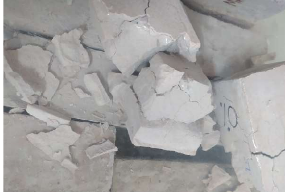
Figura 18: Desintegração os corpos de prova com o ensaio
