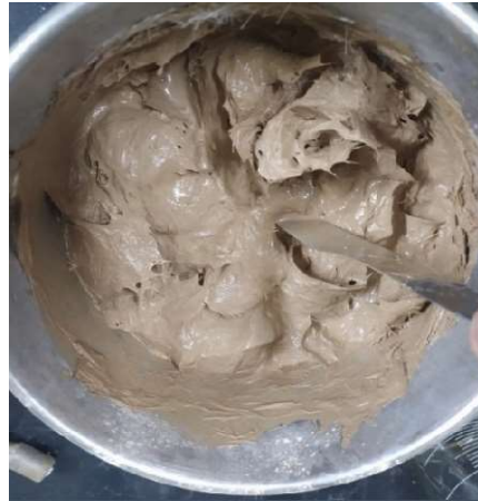
Figura 12: Mistura dos materiais dos compósitos com fibra manualmente
