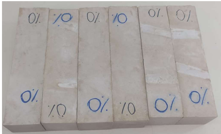
Figura 14: Amostras prismáticas de compósito de cimento MOS após desforma (amostra M0 como exemplo)
