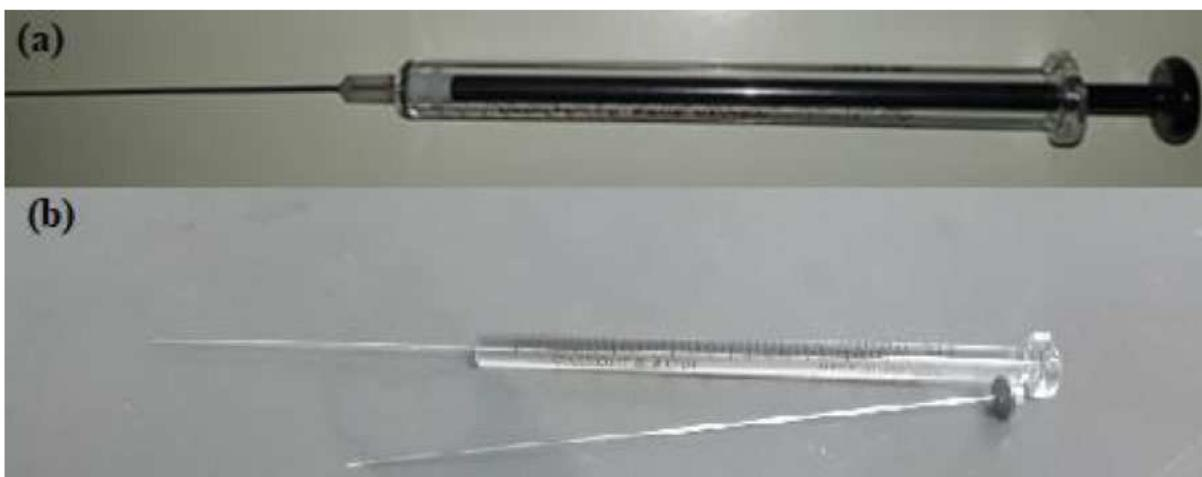
Figura 3.3 – Microseringas utilizadas para coleta e injeção de amostras gasosas (a) Hamilton Gastight 1001, (b) Hamilton Gastight 1701 (SILVA, 2021).
