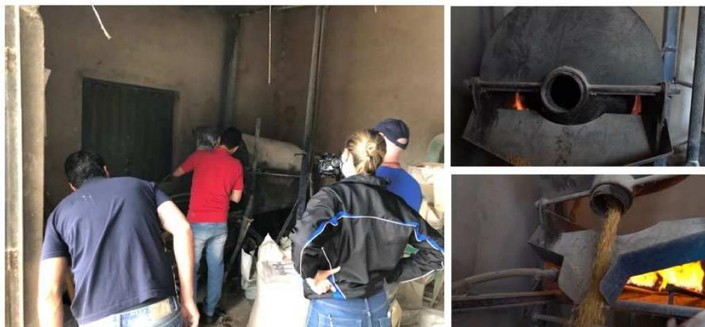
Figura 4.13 – Torrador de soja adaptados para o uso do biogás.
