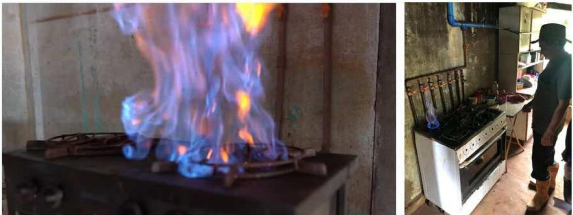
Figura 4.12 – Chama dos fogões adaptados para o uso do biogás.
