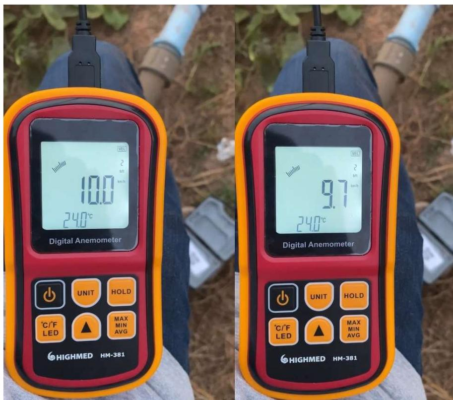
Figura 4.2 – Imagens das medições de velocidades e temperatura realizadas pelo anemômetro.
