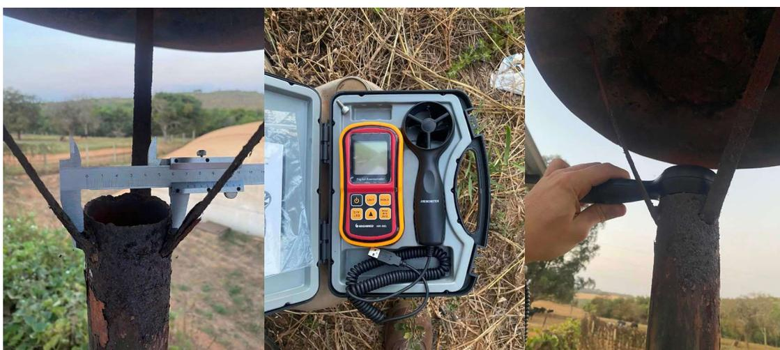
Figura 3.14 – Medições e aparelhos utilizados para cálculo de vazão no queimador do biodigestor da Fazenda Pirapitinga.
