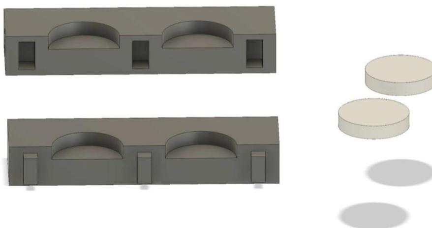
**Figura 1.** Modelo do molde utilizado para confecção dos corpos de prova com CIVc.
