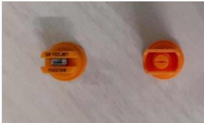
**Figura 1.** Pontas de pulverização utilizadas: Teejet XR 11001 e Agrotop Airmix 11001.
