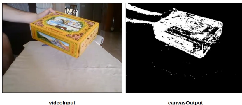
Figura 2 – Aplicação da técnica de subtração de fundo baseada em modelos de Mistura Gaussiana
