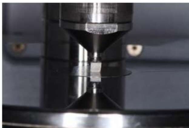
Fig. 3. Amostra posicionada sobre o cristal de diamante.
