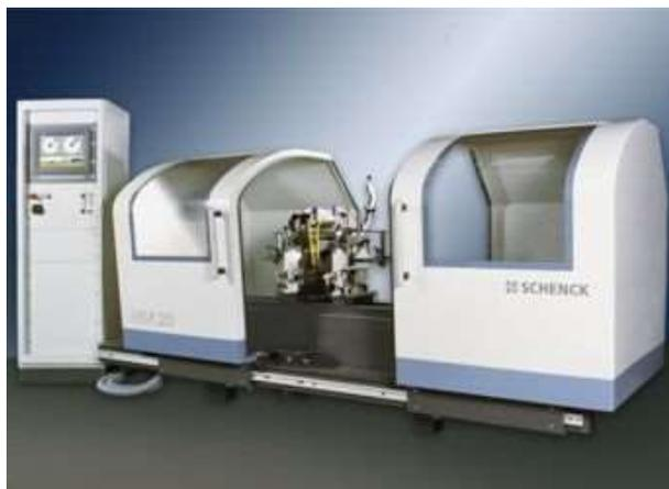
Figura 14 – Máquina balanceadora (Schenck, 2024)
