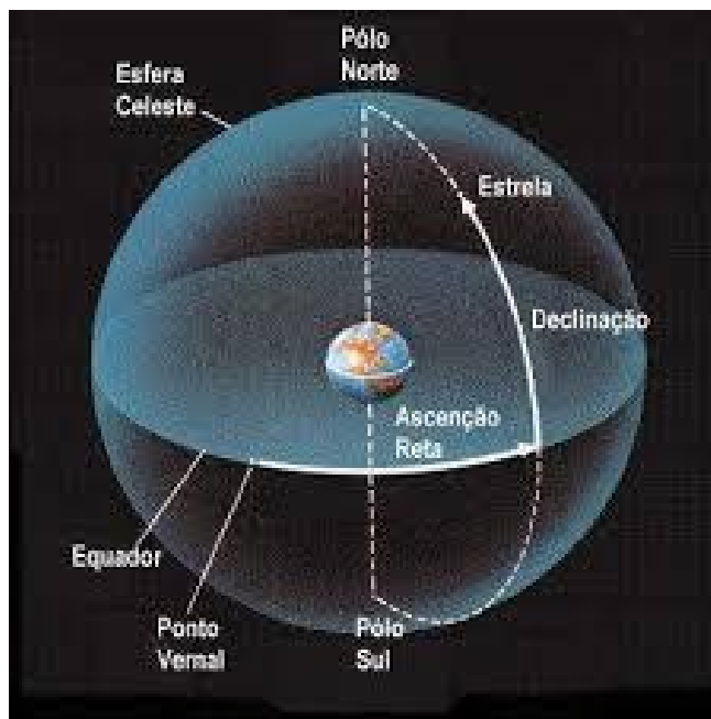
Figura A-1.1: A figura apresenta o Sistema de Referência Equatorial Celeste. A ascensão reta é o ângulo medido a partir do centro da esfera sobre o Equador Celeste, iniciando do Ponto Vernal e crescendo na direção Leste. A declinação é o ângulo medido a partir do centro da esfera iniciando no Equador Celeste em direção aos polos.
