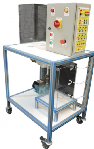
Figura 2.5 - Kit didático para controle de nível da Dienzo.
