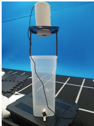
Figura 4.9 - Sensor ultrassônico posicionado em cima do tanque.
