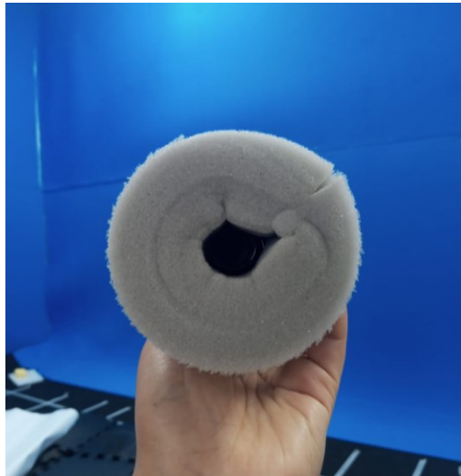
Figura 4.8 - Espuma em volta do sensor ultrassônico.
