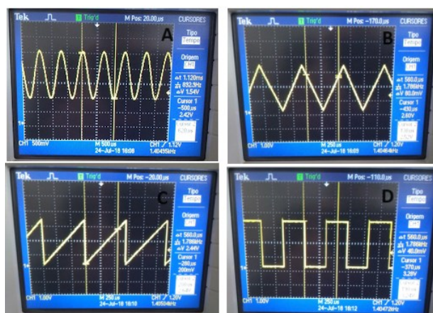
Figura 53 - Ondas resultantes do módulo amplificador: A) Senoidal; B) Triangular; C) Dente-de-serra; D) Quadrada.
