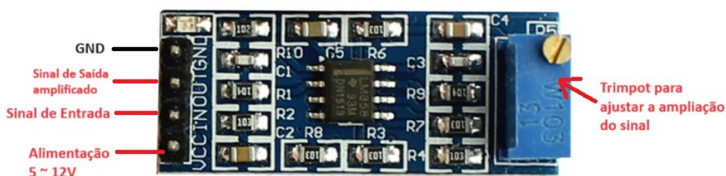
Figura 22 - Módulo Amplificador Operacional LM358.
