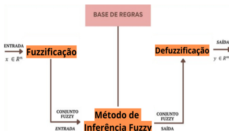
Figura 4 – Esquema do Sistema Baseado em Regras Fuzzy
