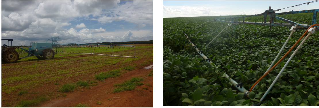
FIGURA 1. a) Barra auxiliar acoplada ao pulverizador na área de estudo avaliada. b) Detalhe dos bastões flexíveis que promovem a ligação entre a barra auxiliar a barra principal do pulverizador.
