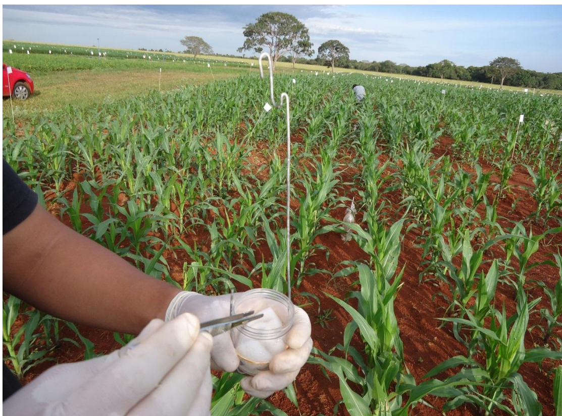
Figura 4- Coleta da lâmina de espuma com nitrogênio volatilizado.
