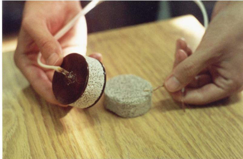
Figura 2. Foto do sensor mostrando as duas placas paralelas envernizadas e o dielétrico poroso de pedra-pomes ao centro.
