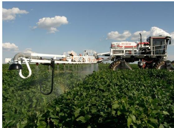
Figura 4. Pulverizador autopropelido utilizado nas aplicações foliares de defensivos agrícolas, fertilizantes e bioestimulantes.
