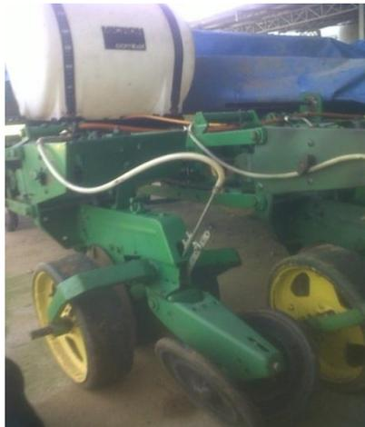
Figura 2. Semeadora adaptada com sistema de injeção de calda no sulco de semeadura para aplicações de bioestimulantes.
