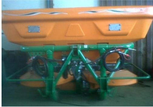
Figura 3. Distribuidor centrífugo para adubação potássica a lanço na área experimental.
