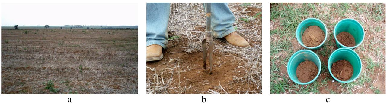
**Figura 1.** Detalhe da área amostrada (a), do Trado Holandês (b) e das amostras compostas (c).
